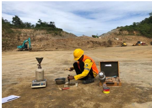
Gambar 3.5 Pengujian SandCone (sumber: dokumentasi kerja praktek 2023)
