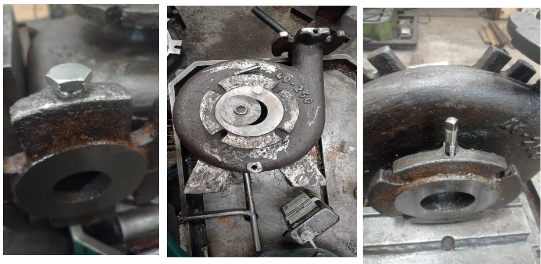
Gambar 4.4 rumah pompa sumber: PT.Victorindo Pratama Mandiri
