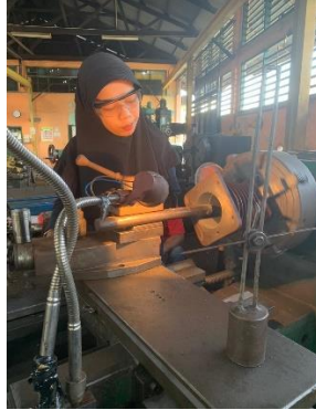
Gambar 4. 17 Pembubutan Diameter Dalam Sumber. Dokumentasi.
