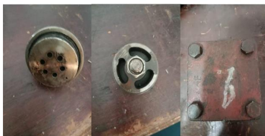
Gambar 4. 24 Pemasangan palve Exhouse , intake , Cap Sumber. Dokumentasi.
