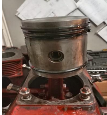
Gambar 4. 21 Pemasangan Piston Sumber. Dokumentasi.
