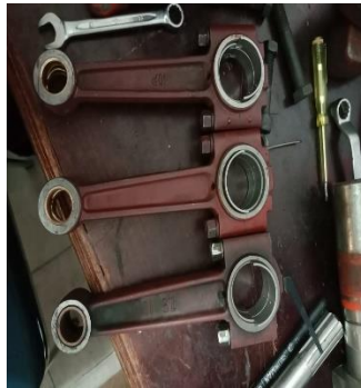
Gambar 4. 15 Pemasangan Metal Bering Sumber. Dokumentasi
