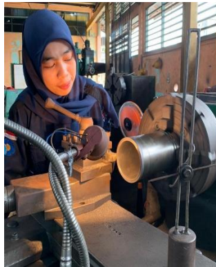
Gambar 4. 18 Pembubutan Rata ( Silendris ) Sumber. Dokumentasi.
