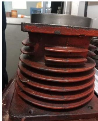
Gambar 4. 22 Pemasangan Blok Kompresor Sumber. Dokumentasi
