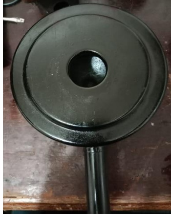
Gambar 4. 27 Pemasangan Filter udara kompresor Sumber. Dokumentasi.
