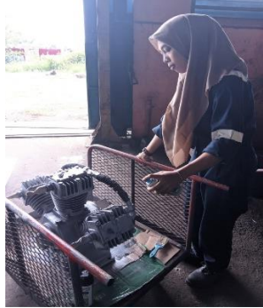
Gambar 4. 25 Pengecatan Awal Sumber. Dokumentasi.
