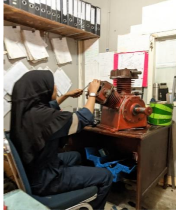
Gambar 4. 23 Pemasangan Kepala Silinder Sumber. Dokumentasi.
