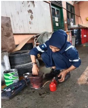
Gambar 4. 20 Memasukkan Boring Pada Blok Kompresor Sumber. Dokumentasi
