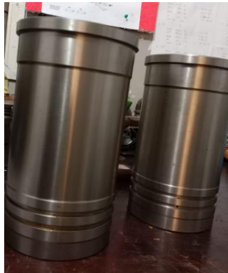
Gambar 4. 11 Liner Boring Sumber. Dokumentasi.
