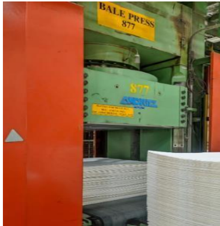
Gambar 3.8 bal setelah di press
