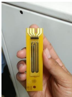
Gambar 3. 22 Sensor Korosi Atmosfer
