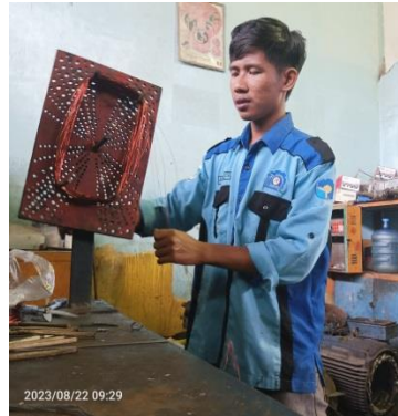
Gambar2. 61 Menggulung lilitan pada motor crane
