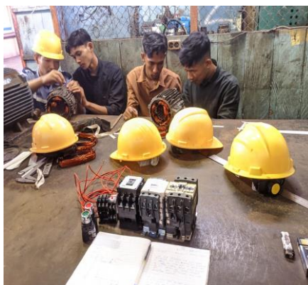
Gambar2. 5 pemasangan lilitan tiga phasa
