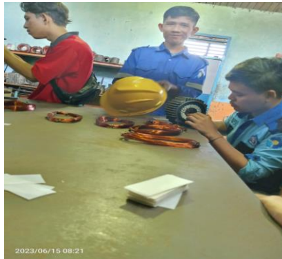
Gambar2. 8 pemasangan lilitan pada motor 3 phasa
