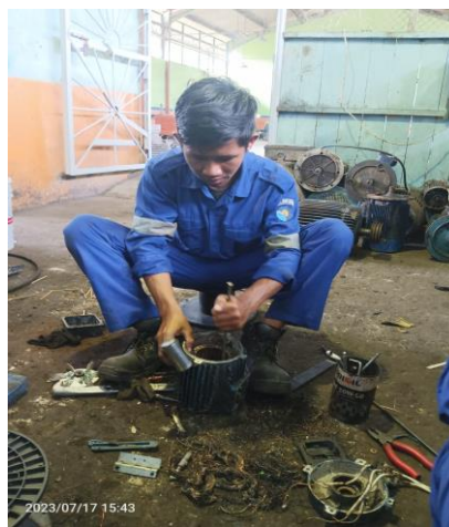
Gambar2. 31 Pembongkaran lilitan motor 3 phase
