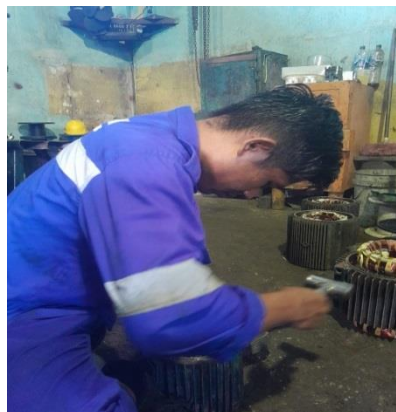
Gambar2. 30 membuka lilitan conveyor 3phasa
