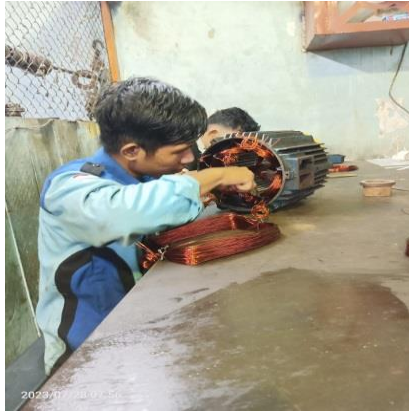
Gambar 2. 41 Pemasangan gulungan pada motor 3 fasa
