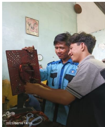
Gambar2. 56 Menggulung lilitan motor pompa pengutipan
