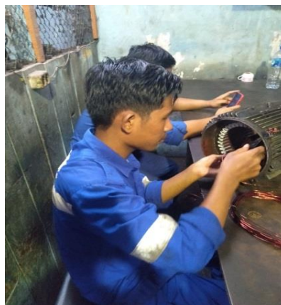
Gambar2. 54 Memasang lilitan pada motor conveyor
