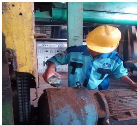
Gambar2. 19 mengisi oli pada motor polishing drum
