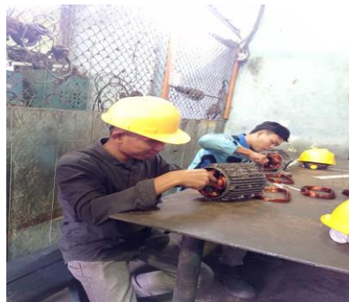
Gambar2. 3. Memasang lilitan motor 3 phasa 2,5 kw
