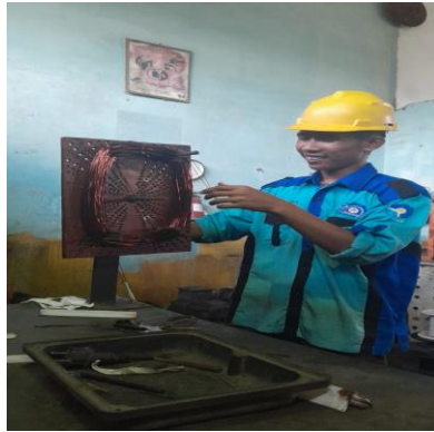
Gambar2. 14 menggulung lilitan untuk motor conveyor 3 phasa
