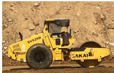
Gambar 3.9 Vibration Roller (Sumber : Dokumentasi Kerja Praktek,2023)
