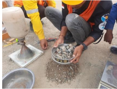
Gambar 3.33 Pengujian Sand Cone (Sumber : Dokumentasi Kerja Praktek,2023)
