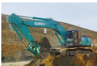
Gambar 3.4 Excavator SK330 (Sumber : Dokumentasi Kerja Praktek,2023)
