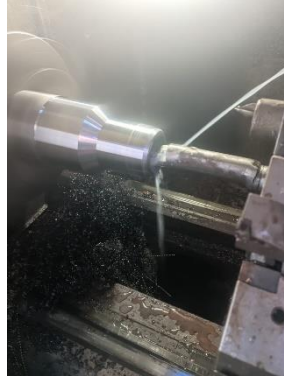
Gambar 4. 5 Pembubutan Dalam Sumber: Dokumentasi
