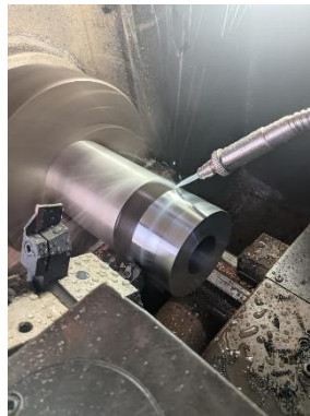
Gambar 4. 7 PembubutanRata dan Facing Sumber: Dokumentasi
