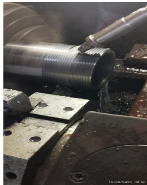
Gambar 4. 8 pembuatan ulir Sumber: Dokumentasi
