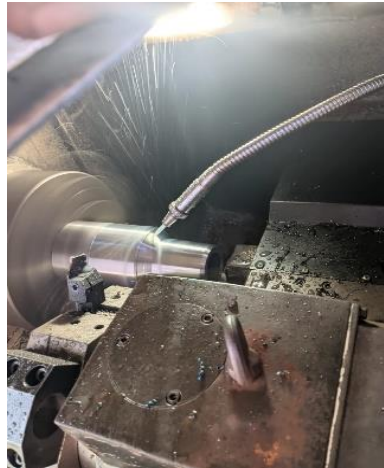
Gambar 4. 4 Pembubutan Rata dan Facing Sumber: Dokumentasi
