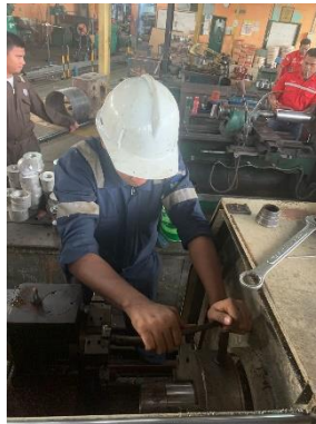
Gambar 4. 3 Pemasangan Benda Kerja Pada Cekam Sumber: Dokumentasi
