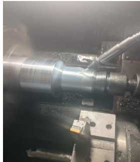
Gambar 4. 6 pembuatan ulir Sumber: Dokumentasi
