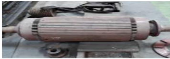
Gambar 3.11 Kondisi Rotor sebelum overhaul ( Sumber : Dokumentasi 2023 )
