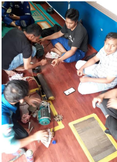
Gambar 2.35 Memerbaiki motor 1 fasa (Sumber: Dokumentasi 2023)
