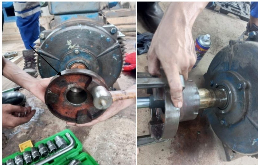
Gambar 3.5 Kopling (Sumber : Dokumetasi 2023)
