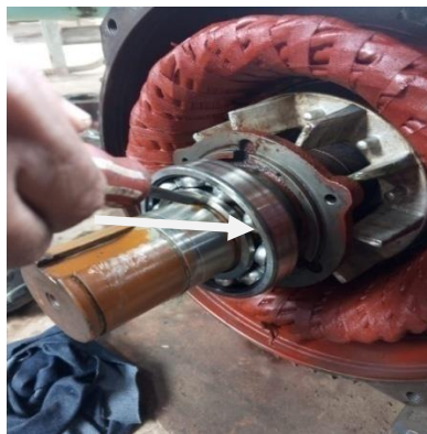
Gambar 3.4 Bearing (Sumber: Dokumentasi 2023)
