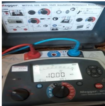
Gambar 3.12 Pengukuran Hasil IR menggunakan Megger ( Sumber : Dokumentasi 2023 )
