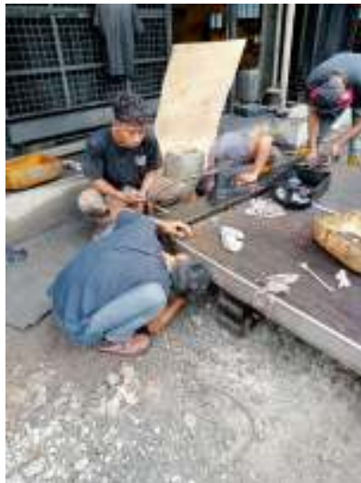
Gambar 2.31 Kegiatan pembersihan radiator (Sumber: PT. Megapower Makmur Tbk, 2023)
