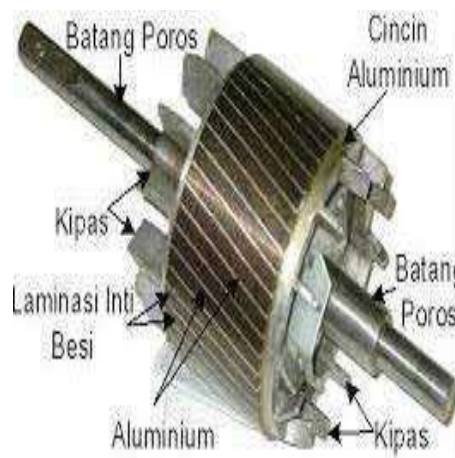
Gambar 3.4 Rotor Sangkar Tupai (Sumber : Google )
