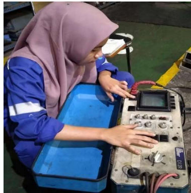
Gambar 2.32 Surge Test (Sumber : Dokumentasi )
