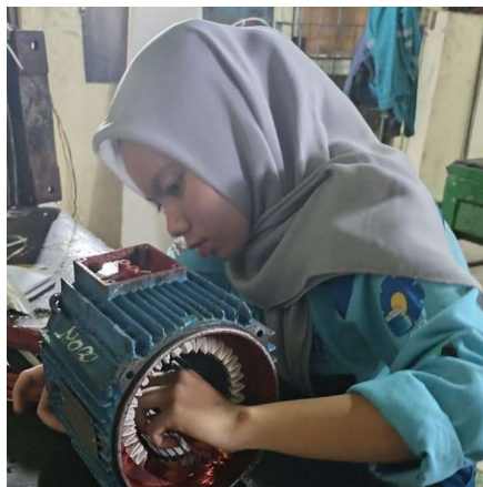
Gambar 2.16 Pemasangan Coil (Sumber : Dokumentasi )
