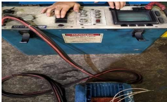
Gambar 4.5 Surge Test (Sumber : Dokumentasi )
