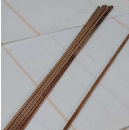
Gambar 4.12 Kawat Las (Sumber : Dokumentasi )
