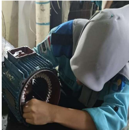
Gambar 2.15 Pemasangan Nomex (Sumber : Dokumentasi )
