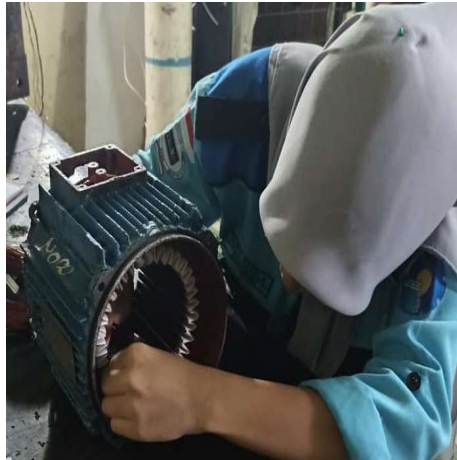
Gambar 2.19 Pemasangan Coil (Sumber : Dokumentasi )
