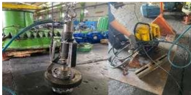
Gambar 4. 9 Proses membuka bearing menggunakan tracker Sumber: Dokumentasi Pribadi
