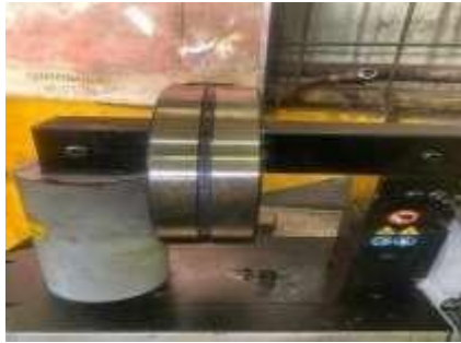
Gambar 4. 10 Pemanasan bearing menggunakan heater bearing
