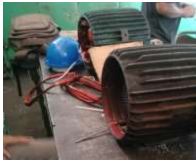
Gambar 2. 40 Membongkar kumparan kawat dari stator Sumber : Dokumentasi 2023
