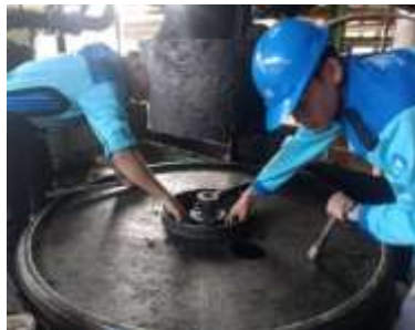
Gambar 2. 20 Mengganti Filter vibrating screen Sumber : Dokumentasi 2023
