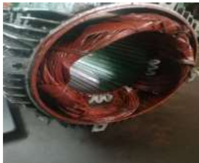
Gambar 2. 42 Rewinding 1 kutup elektromotor yang rusak Sumber : Dokumentasi 2023
