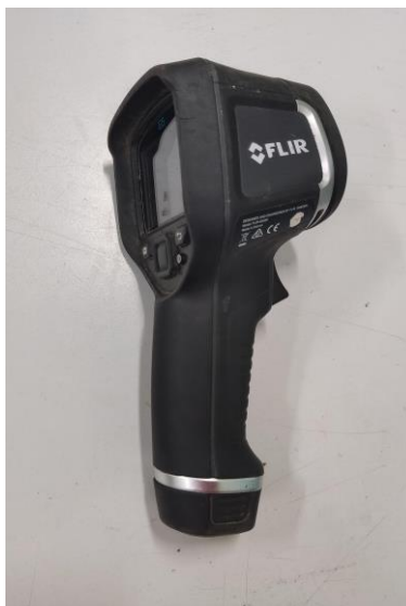
Gambar 3. 2 Thermograph Sumber : Como RPL Office, PT. RAPP
