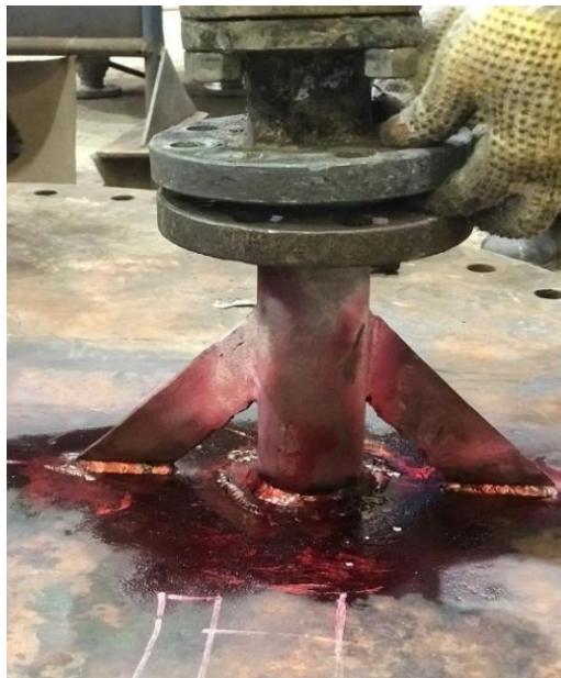
Gambar 4. 7 Proses Penyemprotan Red Penetrant Ke Matrial Sumber : Workshop PT. RAPP
