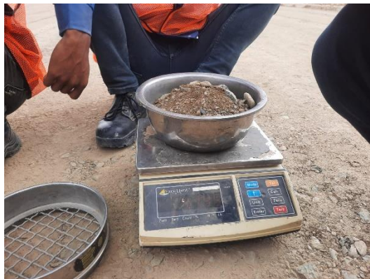
Gambar 3. 35 Sand Cone Test Sumber : Dokumentasi Kerja Praktek, 2023
