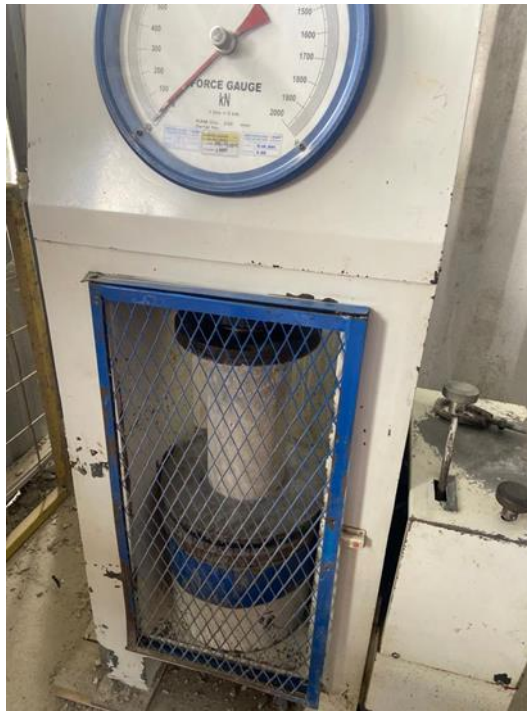
Gambar 3. 41 Uji Tekan Material LC Sumber : Dokumentasi Kerja Praktek, 2023
