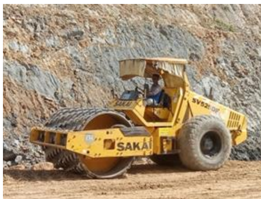
Gambar 3. 8 Sheep Foot Rollers Sumber : Dokumentasi Kerja Praktek, 2023
