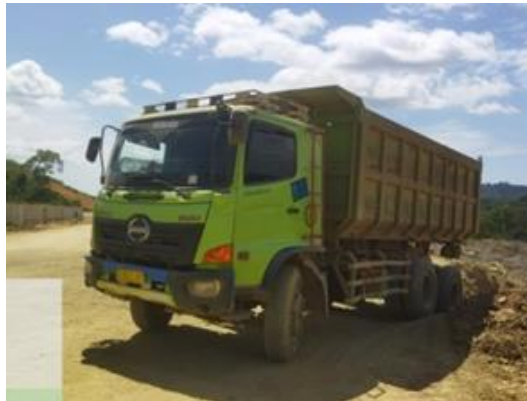
Gambar 3. 1 Dump Truck FM260JD Sumber : Dokumentasi Kerja Praktek, 2023
