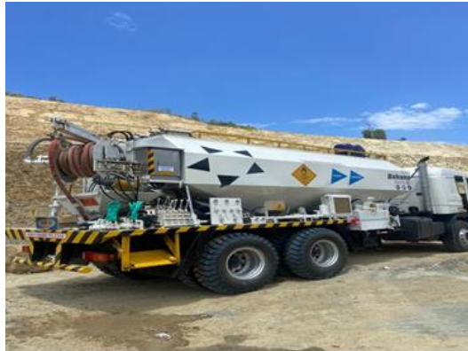
Gambar 3. 21 Pengisian Bahan Peledak Sumber : Dokumentasi Kerja Praktek, 2023
