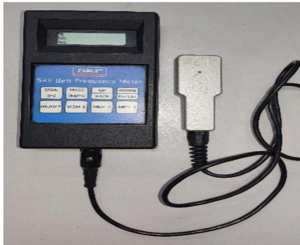
**Gambar 3. 3** Alat Pengukur Frekuensi V-belt
