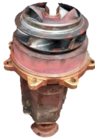
Gambar 4.17 Pompa Yang Sudah Diperbaiki
