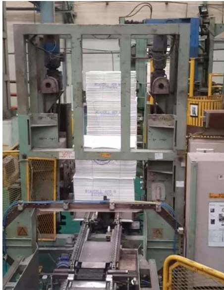
Gambar 3.5 Bale Stacker menumpuk 2 bale
