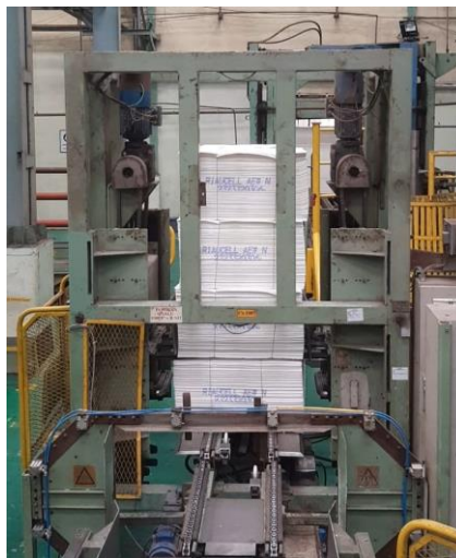
Gambar 3.6 Bale Stacker menumpuk 4 bale
