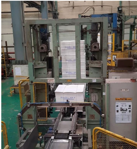
Gambar 3.4 Bale masuk ke Bale Stacker
