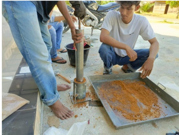
Gambar 3. 67 Pengujian Proktor (Sumber : Dokumentasi Lapangan 2023)
