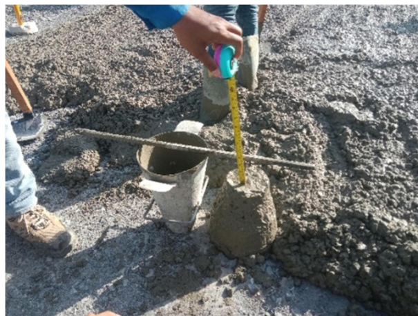
Gambar 4. 15 Pengujian slump beton
