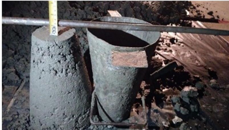
Gambar 3. 54 Pengujian Slump Beton (Sumber : Dokumentasi Lapangan 2023)
