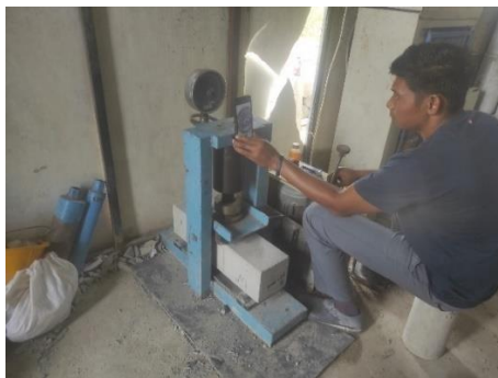
Gambar 4. 8 Pengujian Kuat Lentur Beton Sumber : Dokumentasi Kerja Praktek 2023
