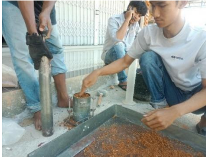
Gambar 3. 17 Pengujian Proctor Sumber : Dokumentasi Kerja Praktek 2023
