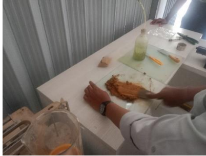
Gambar 3. 14 Pengujian Plastic Limit Sumber : Dokumentasi Kerja Praktek 2023
