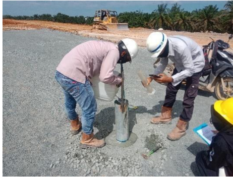
Gambar 3. 3 Pengujian Permeabilitas Sumber : Dokumentasi Kerja Praktek 2023
