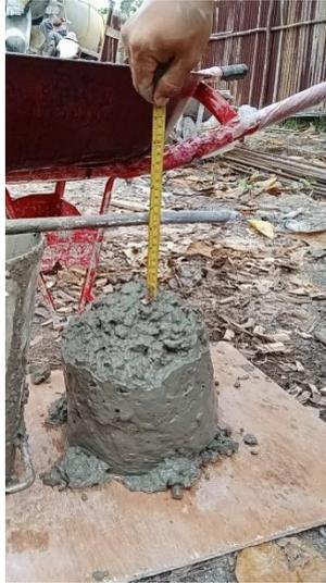
Gambar3.4 Uji Slump Test Mutu beton K-250 untuk sloof
