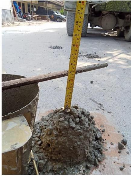
Gambar3.8 Pengujian Slump test Mutu Beton K-250 pada Kolom
