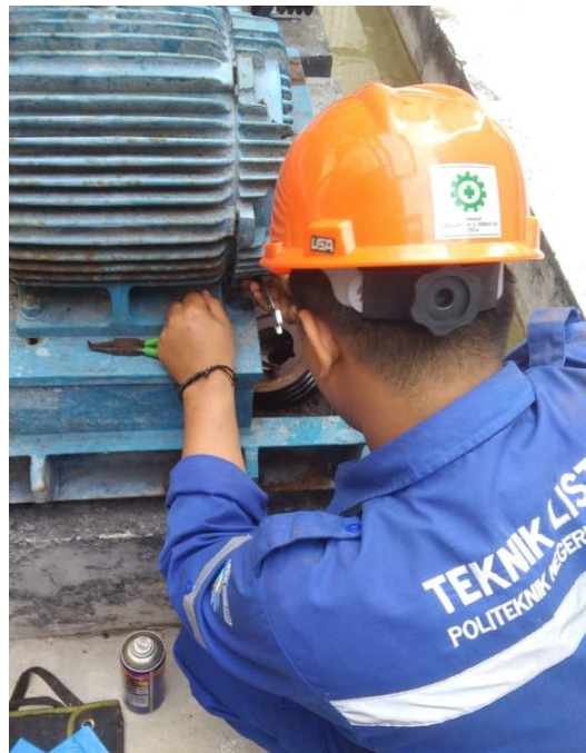
Gambar 2.1 Motor Induksi 3 Phase (Sumber : Dokumentasi penulis,2023)
