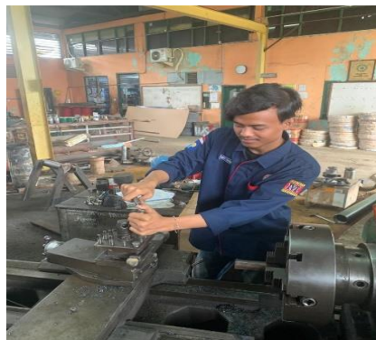
Gambar 4. 5 Pemasangan mata pahat
