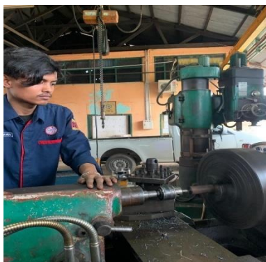
Gambar 4. 8 Pengeboran menggunakan center drill
