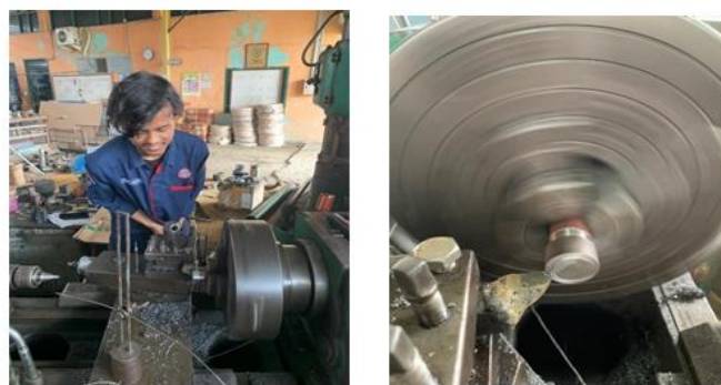
Gambar 4. 13 Pembubutan kepala pin
