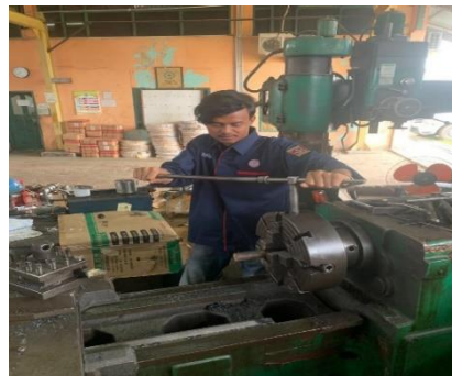
Gambar 4. 3 Pemasangan benda kerja pada cekam
