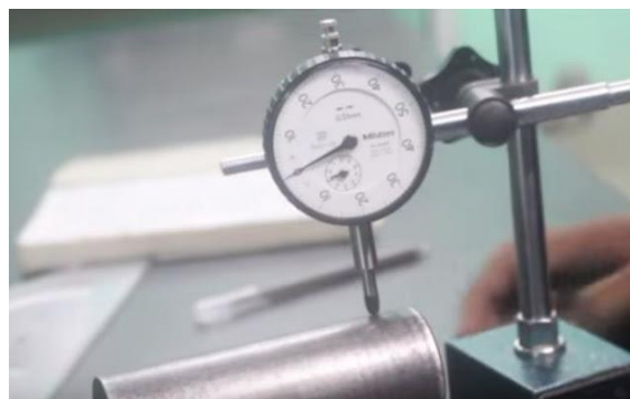
Gambar 4. 4 settingan benda kerja menggunakan dial indikator
