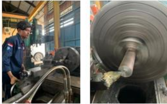
Gambar 4. 7 Pembubutan muka (facing)
