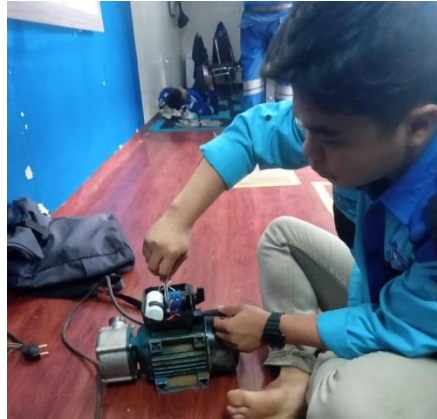
Gambar 2. 39 Proses perbaikan selektor kapasitor Motor fuel pump oil (Sumber : Dokumentasi 2023)
