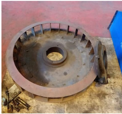
Gambar 3. 10 Fan Motor (Sumber: Dokumentasi 2023)
