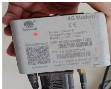
Gambar 2. 22 Penggantian Modem (Sumber : PT. PLN (Persero) ULP Bangkinang 2023)
