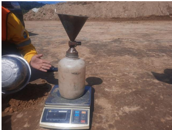
Gambar 3.15 Menimbang Berat Pasir Dan Corong (Sumber : Dokumentasi Kerja Praktek, 2023)
