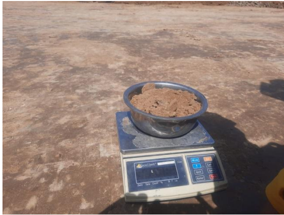
Gambar 3.14 Menimbang Berat Tanah Hasil Penggalian (Sumber : Dokumentasi Kerja Praktek, 2023)
