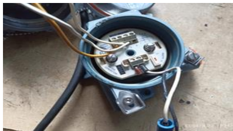
Gambar 2. 1 Wiring Transmitter (sumber: dokumen penulis, 2023)
