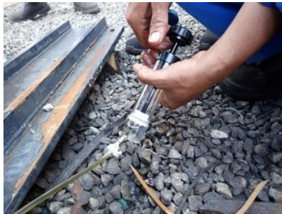
Gambar 2.1 Proses pengambilan sampel minyak trafo Sumber: (Dokumentasi, 2023)
