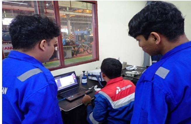
Gambar 2.2 Proses pengecekan isolasi minyak menggunakan Myrkos Morgan Schaffer dengan PPM Report Sumber: (Dokumentasi, 2023)
