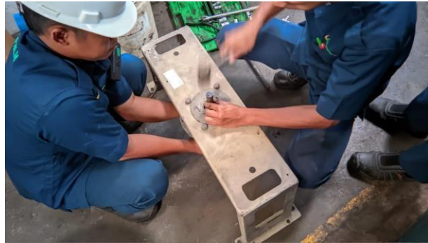
Gambar 2.19 Proses pembongkaran bearing Sumber: (Dokumentasi, 2023)
