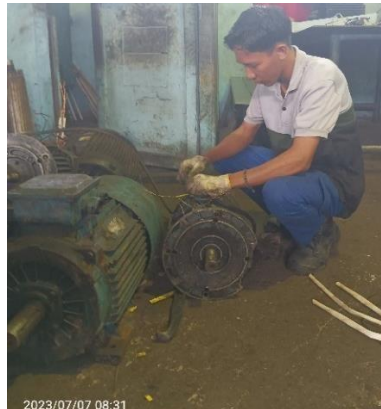
Gambar 2. 25 Mengcouple elmot dan menguji elmot
