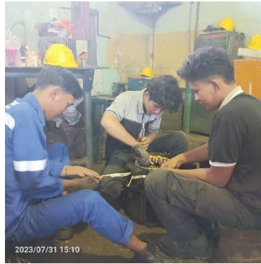
Gambar 2. 44Mengcouple/merakit elmot dan menguji elmot
