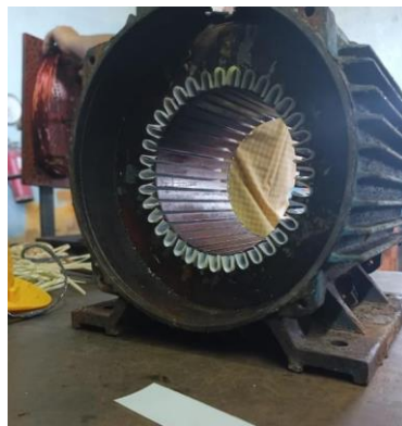
Gambar 2. 16 Pemasangan kertas gulung dinamo
