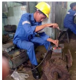
Gambar 2. 27 Merangkai elmot hubungan Star dan Delta
