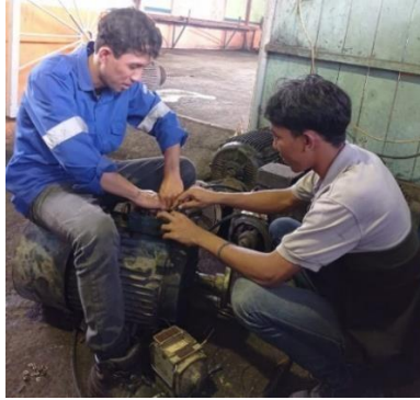
Gambar 2. 57Mencouple/merakit elmot dan menguji elmot
