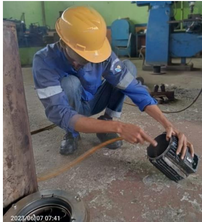
Gambar 2. 3membongkar dan membersihkan elmot
