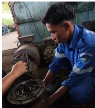
Gambar 2. 19Membongkar elmot rusak
