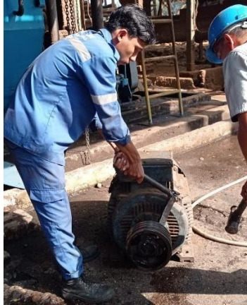
Gambar 2. 52Menurunkan elmot rusak dan membongkar pully elmot
