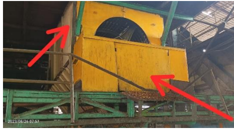
Gambar4. 3Body thresher dan pintu-pintu mengarahkan brondolan jatuh ke below conveyor
