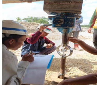
Gambar 3.8 Pengujian Pengujian Proofrolling dan CBR Lapangan
