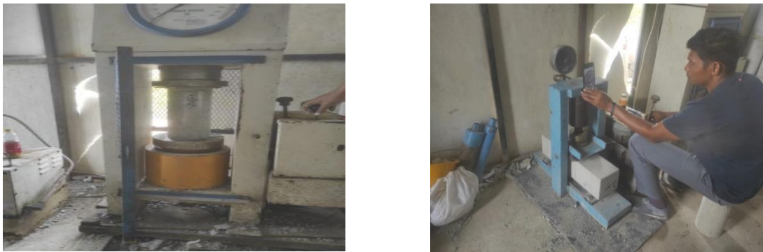
Gambar 3.10 Pengujian Kuat Tekan Beton & Kuat Lentur Beton
