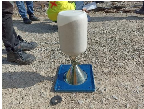
Gambar 3.2 Pekerjaan Sand Cone Test (Sumber: Dokumentasi Lapangan)
