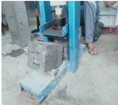
Gambar 3. 15 uji kuat tekan beton
