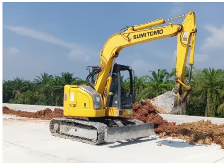
Gambar 4. 2 mini hidraulyc excavator
