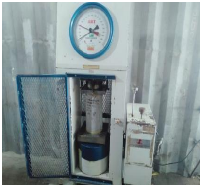
Gambar 3. 16 uji kuat tekan beton
