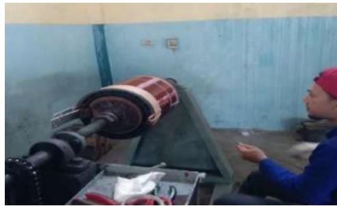
Gambar 2.12 Ganti Kawat Email Trafo Sumber: Dokumentasi, 2022
