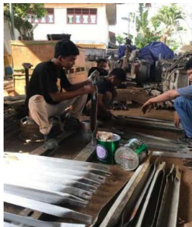
Gambar 2.19 Pengecatan Besi Alambres Sumber: Dokumentasi, 2022
