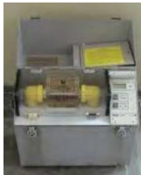
Gambar 3.18 Test Tegangan Tembus Minyak Sumber: (Brist, 2023)
