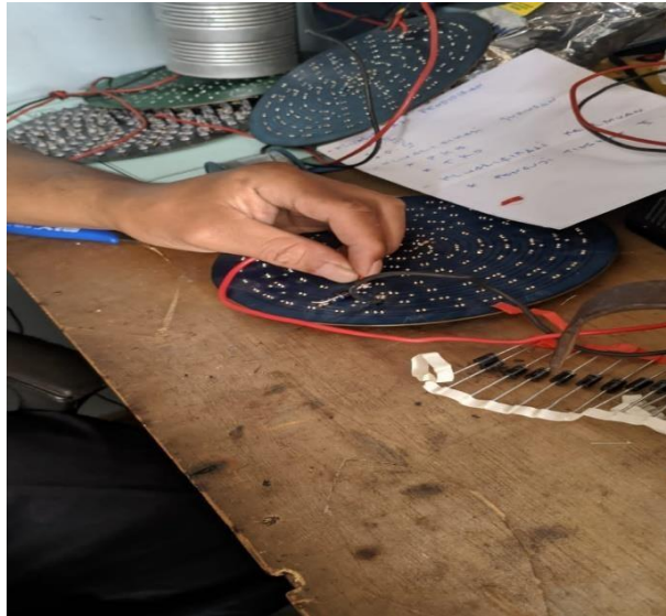
Gambar 3.3 Pemasangan Dioda Pada LED
