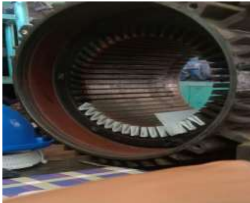
Gambar 2. 36 Rewinding Elektromotor Sumber Dokumentasi 2023
