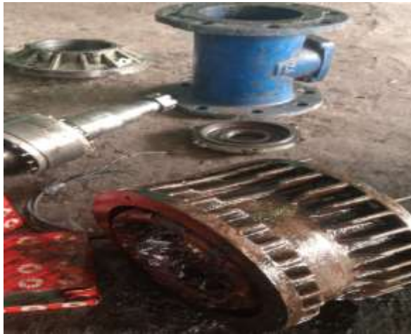
Gambar 2. 44 Perbaikan Pompa Transfer Sumber Dokumentasi
