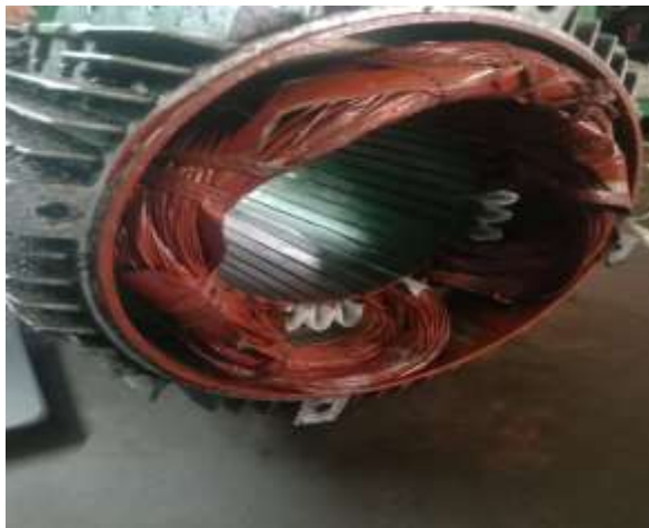
Gambar 2. 45 Rewinding Elektromotor Sumber Dokumentasi 2023
