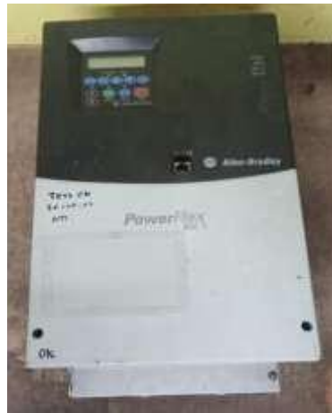
Gambar 3. 1 Panel Variable Speed Drive(VSD) (Sumber: Dokumentasi 2022)
