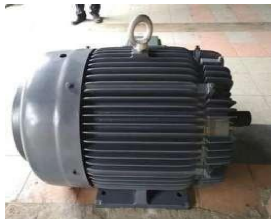
Gambar 3. 9 Motor induksi 3 phasa (Sumber : Dokumentasi 2022)
