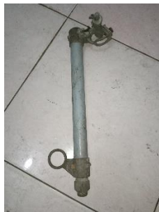
Gambar 3.10 Fuse cut out Sumber (Dokumentasi, 2023)
