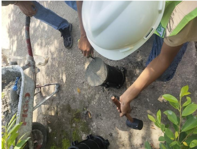
Gambar 24 Pembuatan Benda Uji
