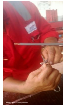
Gambar 3.15 membuka karet kabel (Dokumentasi pribadi 2023)
