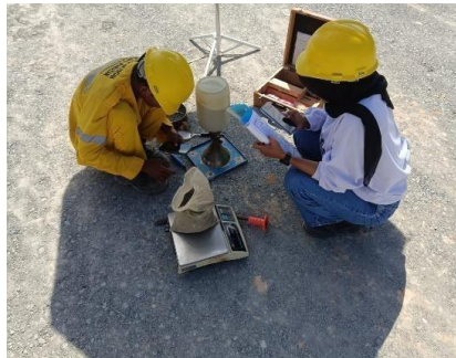
Gambar 3.5 pengujian sand cone Sumber : Dokumentasi Kerja Praktek, 2023
