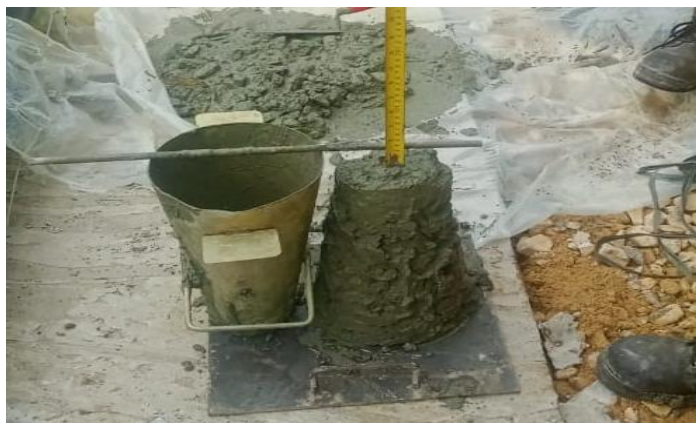
Gambar 3.32 Pengujian Slump (Sumber : Dokumentasi Lapangan)
