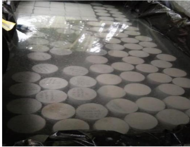
Gambar 3.35 Sampel yang direndam didalam bak berisi air (Sumber : Dokumentasi Lapangan)
