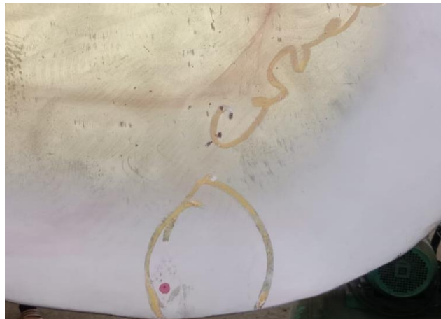
Gambar 2.30 Hasil uji penetrasi test pada propeler
