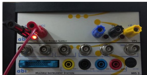
Gambar 3. 2 VPS / Variable Power Supply (Sumber Dokumentasi:2023)
