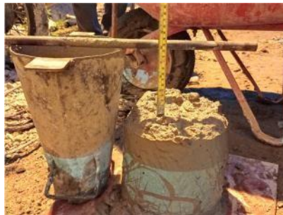
Gambar 3. 29 Pengujian Slump (Sumber : Dokumentasi Perusahaan, 2023)
