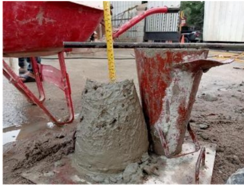
Gambar 3. 14 Pengujian Slump (Sumber : Dokumentasi Lapangan, 2023)
