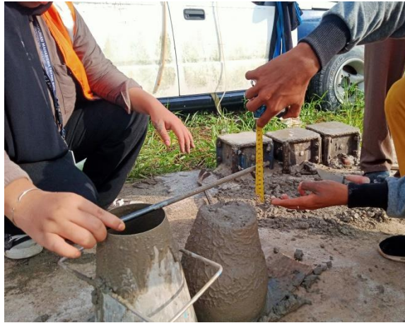
Gambar 3.51 Pengujian Slump (Sumber : Dokumentasi Pribadi, 2023)
