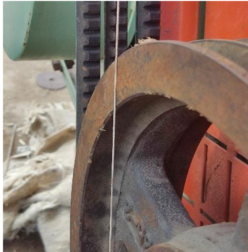
Gambar 4.20 Renggang Tali/Benang Sudah Sesuai Dengan Batas Toleransi (0,05mm)
