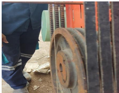
Gambar 4.19 Renggang Tali/Benang Melebihi Batas Toleransi (0,05mm)
