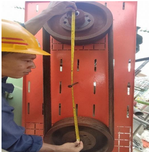
Gambar 4.22 Pengukuran jarak pusat pulley Sumber: PT. RAPP
