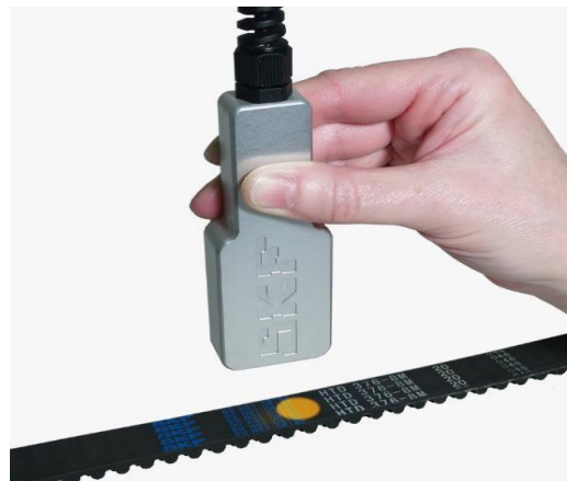
Gambar 4.17 Sensor diarahkan di tengah belt
