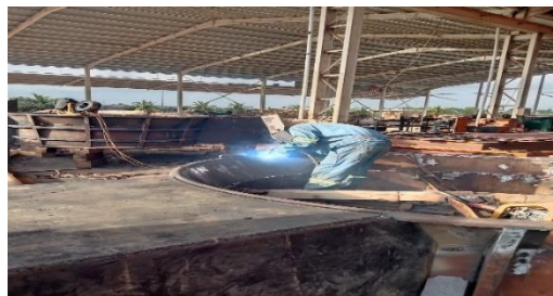
Gambar 3.21 Fabrikasi Kort Nozzle
