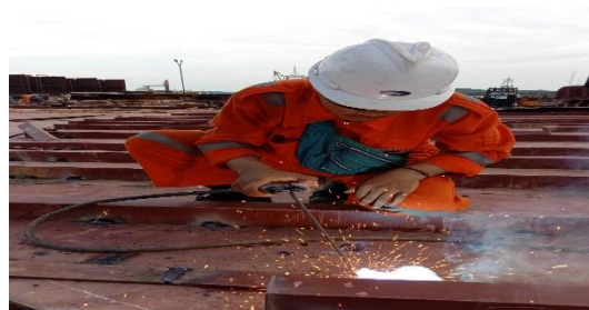
Gambar 2.102 Dokumentasi belajar pengelasan pada konstruksi maindeck tug boat
