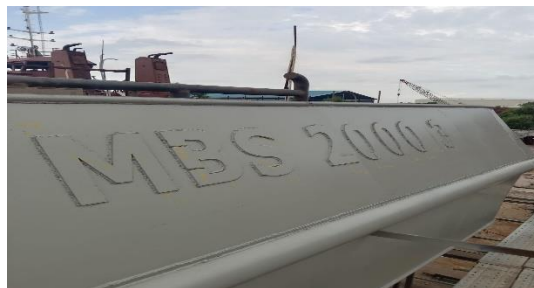
Gambar 2.113 inspeksi pengelasan kupingan dapra , pengelasan nama kapal dan fender
