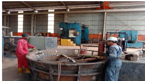
Gambar 2.118 Pengecekan dan pengamatan pembuatan kort nozzle
