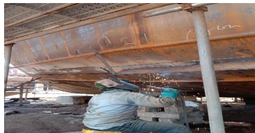
Gambar 2.68 Posisi Pengelasan Overhead dan Fillet Pada Sirip Kapal
