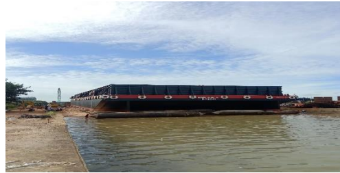
Gambar 2.42 Launching Kapal metode balon zig zag
