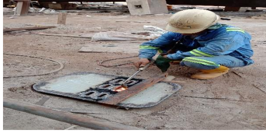
Gambar 2.108 marking plate pada pemotongan kotak sea chest
