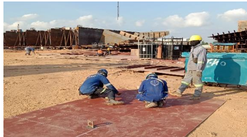
Gambar 2.85 Marking Pada Kapal Tug Boat Hull 29
