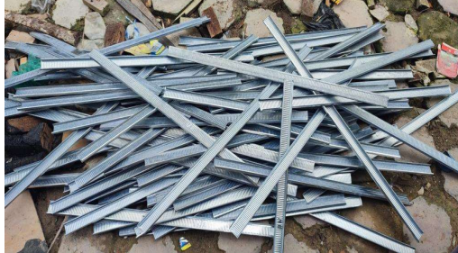
Gambar 3. 91 Furing Rangka Plafond (Sumber): Dokumentasi Lapangan 2023
