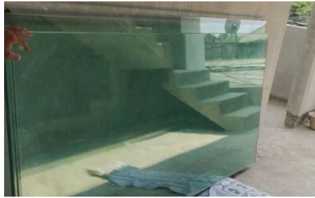
Gambar 3. 109 Kaca Tempered Tebal 12 Mm (Sumber): Dokumentasi Lapangan 2023
