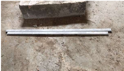
Gambar 3. 130 Jidar (Sumber): Dokumentasi Lapangan 2023
