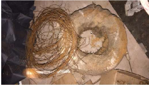
Gambar 3. 89 Kawat Bendrat (Sumber): Dokumentasi Lapangan 2023
