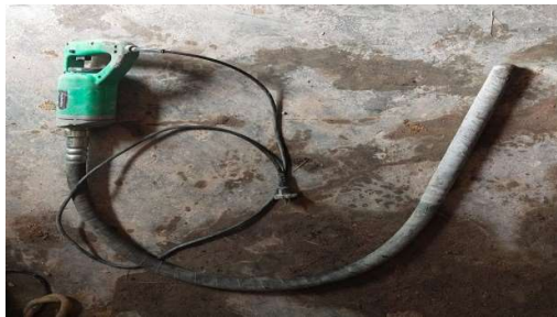
Gambar 3. 112 Concrete Vibrator (Sumber): Dokumentasi Lapangan 2023
