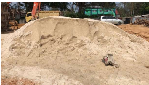
Gambar 3. 86 Agregat Halus (Pasir) (Sumber): Dokumentasi Lapangan 2023
