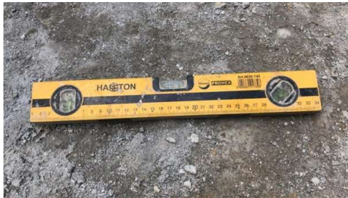
Gambar 3. 128 Waterpass (Sumber): Dokumentasi Lapangan 2023
