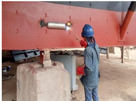
Gambar 3.7 Pemasangan zinc anode pada kapal tongkang SUNJAYA 1001
