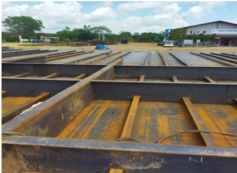
Gambar 2.9 Proses pengecekan hasil las secara visual
