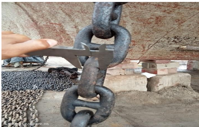
Gambar 2.18 proses kalibrasi rantai jangkar pada kapal TB Endeavor 3
