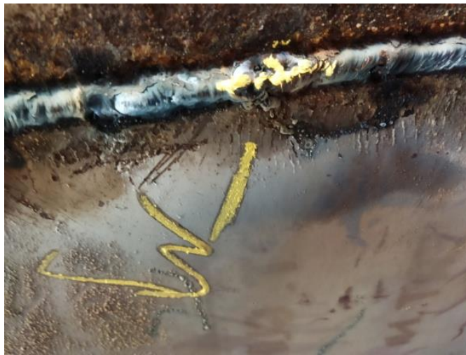
Gambar 3.3.1 Marking di area lasan
